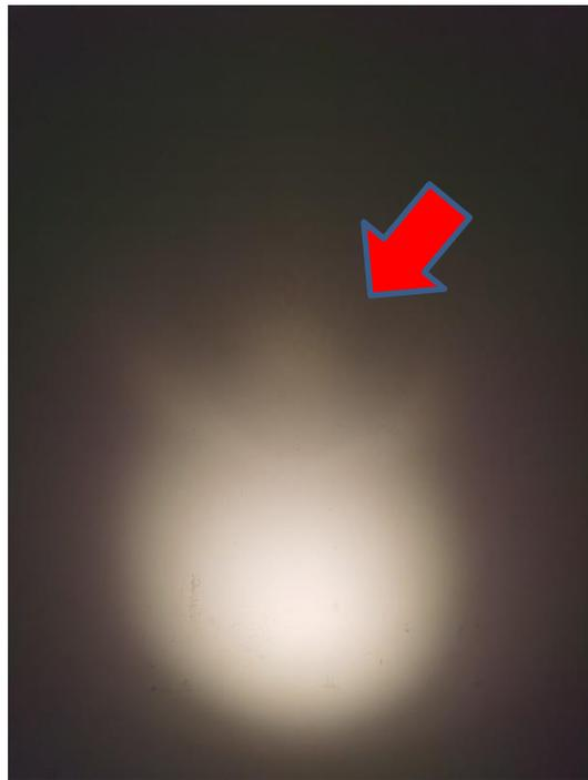
斜口遮光罩，灯具偏光洗墙时候，光斑尾部出现蝴蝶斑，造成光污染
