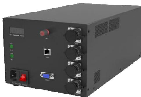
【HV-SXK-XX-XXX-XX-X-XXXX-VX】是我司新推出的多通道时序控制器。为机器视觉 LED 光源提供高速时序切换工作方案。可通过以太网接口与计算机连接，进行远程控制，提供 0~999uS 的脉宽调节方式，最小调节单位 1uS，最大占空比 50%；最大有效外触发频率 100KHz（不同光源触发频率不同，通常情况下，电流小的光源触发频率高，电流大的光源触发频率越低。）。同步响应速度小于 400nS。整机设计具有空气对流通通道，采用强排风冷方式散热，保证电子元器件有良好的散热效果，能更好的延长使用寿命。面板上有 5 位高清数码管，采用编码器选择功能及参数，方便用户更好的操作。
