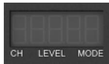
第一位是通道显示，表示当前是第几通道（从上向下依次为 1/2/3/4 通道）的参数；第二、三、四位在模式 2 时是内触发频率，在模式 3~7 时是脉宽显示，实际脉宽为当前显示值加 1；第五位是工作模式显示。时序控制器有 6 种工作模式，模式 2、模式 3、模式 4、模式 5、模式 6、模式 7。模式 2 为内触发时序工作模式；模式 3~7 为外触发时序工作模式。
