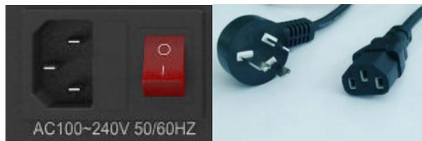
把电源开关按在 I 档时，控制器通电。CPU 进行数据初始化检测完成之后，数码管显示停留在上一次操作的状态，控制器可以进行操作。
