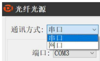
如果连接串口，必须选择对应的正确端口，连接成功后，右下框中会提示“串口打开成功”，右侧“设置”字体由灰色变为黑色字体。
