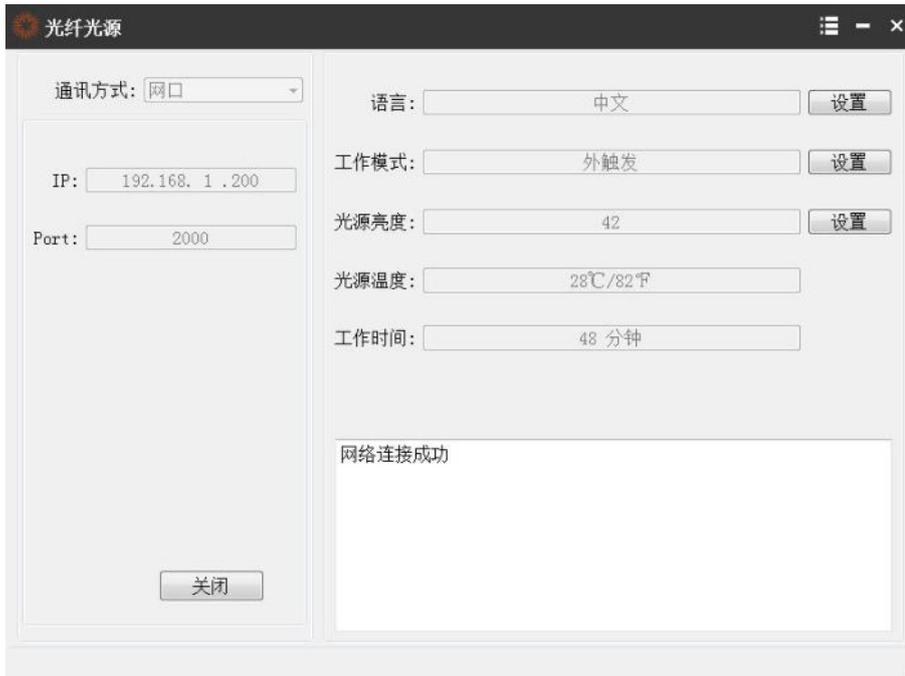
注意：如果选择的是串口通讯，则下面的端口必须要选择对应正确的端口，如果选择的是网口则需要将操作系统上对应网口设置到与设备网口相同的网段。
